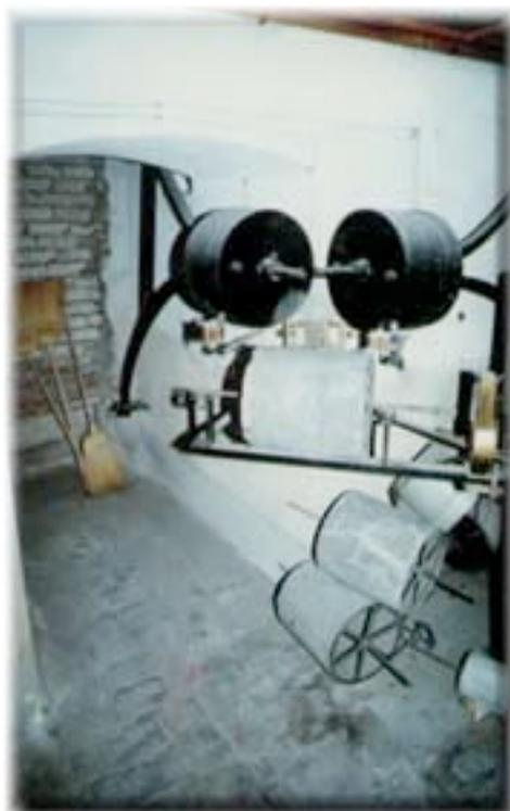
E' tuttora conservato, con la maggior parte della sua strumentazione, l'angolo originale dove Bertelli condusse le sue esperienze con i tromometri. Nell'ambito del Progetto TROMOS sono stati restaurati tutti gli strumenti di Bertelli: il tromometro antico da m 3.30, l'isosismometro, l'ortosismometro e l'orologio a pendolo marcatempo.
